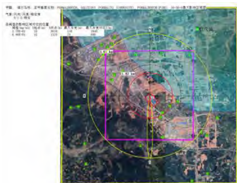
图 4.2-27 甲醛储罐泄漏事故最不利气象 HCl 浓度扩散最大影响范围图
