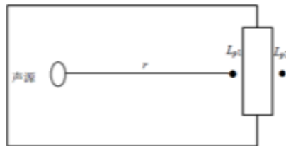
图 4.5-1 室内声源等效为室外声源图例
